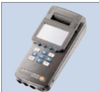
Kontrolní jednotka pro zobrazení naměřených hodnot a řízení měřicího systému
