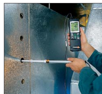
Měření objemového průtoku pomocí časové a místní průměrné (střední) hodnoty
