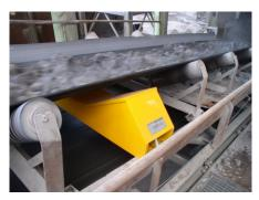
С учетом возможности производства антенн различных форм, например в форме U, дуги, формы V, возможно использование HKP 5.1 на желоба, пневмотранспорт в трубах и т.п. При использовании других форм исходят из спецификаций, указанных в этом руководстве и конструкционная часть антенны проектируется индивидуально.
