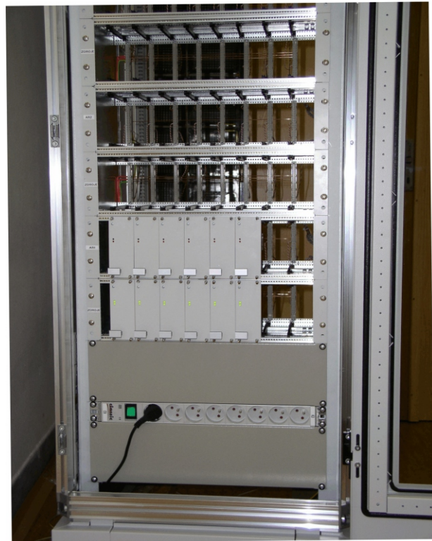
Наземный распределитель SE-RM1 с 6-ю сейсмоакустическими платами SAZ-T1 и 6-ю платами питания SE-S1
